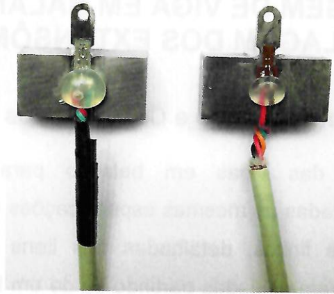
FIGURA II.1 – Vigas em balanço com extensômetros colados.
