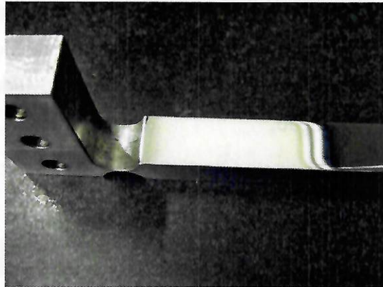
FIGURA 4.28 – Polimento realizado na face inferior da barra de aço mola
