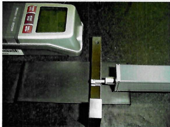
FIGURA 4.29 – Medição da Rugosidade da face inferior da barra de aço mola
