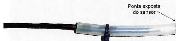
FIGURA 4.21 – Vedação do sensor de temperatura para imersão em água.
