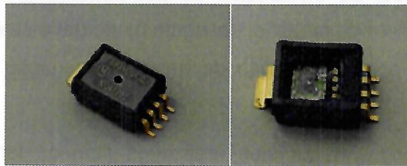
FIGURA 3.26 - Remoção da tampa superior do sensor de pressão para acesso ao diafragma
