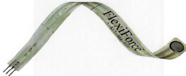
FIGURA 3.28 - Sensor de toque analógico FlexiForce A201. [FONTE: TEKSCAN, (2006)]
