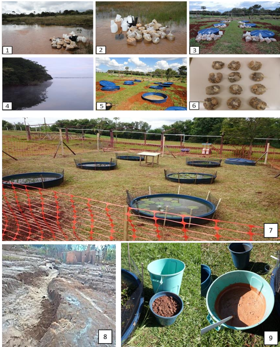
Figura 2: Coleta de amostras de sedimento na represa do Lobo (1 e 2), distribuição dos sedimentos em cada mesocosmo (3), área de coleta de água para enchimento dos mesocosmos na represa do Lobo (4) e mesocosmos preenchidos (5), com base em SANCHEZ (2016). Na foto 7 encontra-se a área experimental, isolada por tratamento, na foto 8 a característica do rejeito coletado no subdistrito de Paracatu de Baixo em setembro de 2016 e na foto 9 o rejeito antes e após mistura com água proveniente do poço artesiano do CRHEA (VOLPE, 2018) no início do experimento (abril de 2017).
