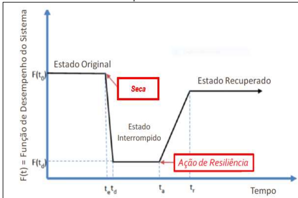
Figura 4. Representação gráfica do estado funcional de um sistema antes, durante e depois de um evento perturbador
