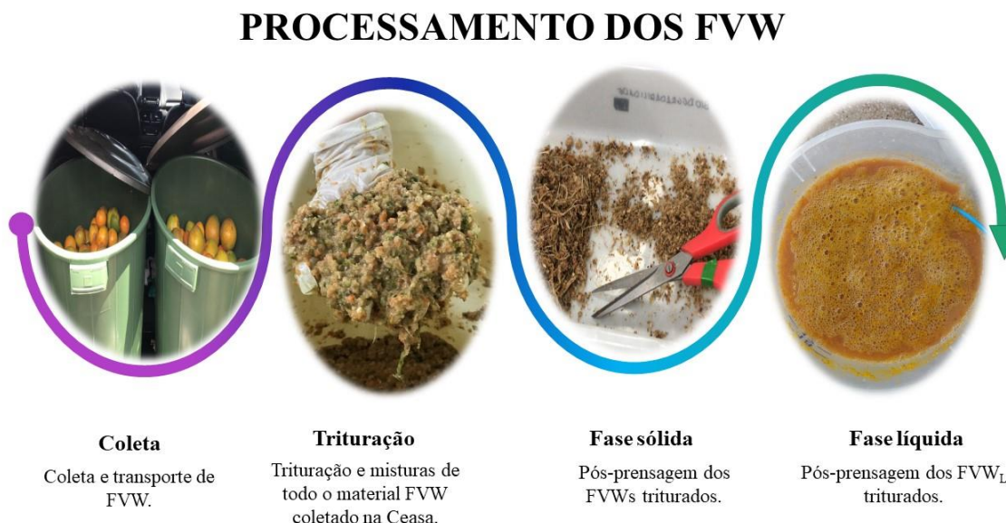
Figura 17 -Fluxo do processamento mecânico para a obtenção da fração líquida do resíduo de frutas e verduras (FVWL).
