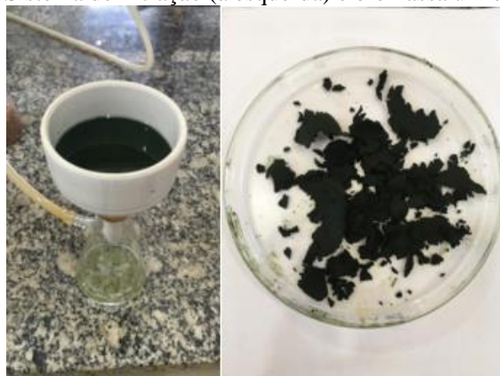
Figura 11: Sistema de filtração (à esquerda) e biomassa úmida (à direita)
