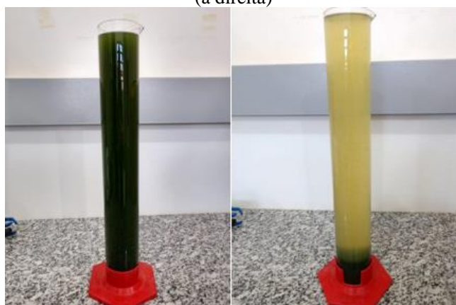
Figura 10: Meio de cultivo antes (à esquerda) e após a adição da solução floculante de sulfato de alumínio (à direita)
