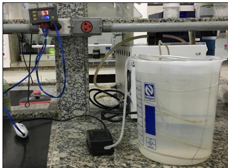
Figura 10 - Teste para fornecimento de ar
