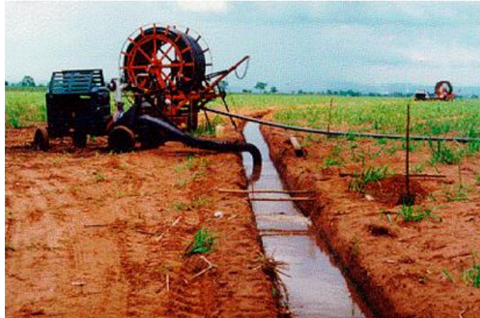
Figura 16: Sistema de irrigação da vinhaça do tipo alimentado por canais (canal + motobomba)
