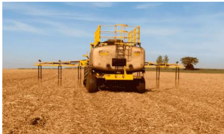
Figura 17: Sistema de transporte e irrigação da vinhaça com caminhão tanque
