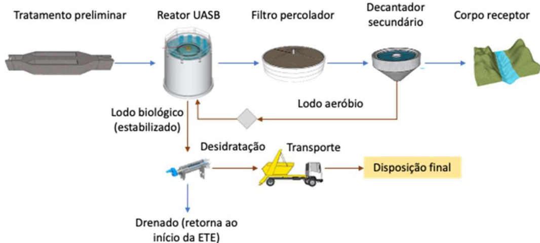
Figura 19 – Desenho esquemático dos processos da ETE Laranja Azeda
