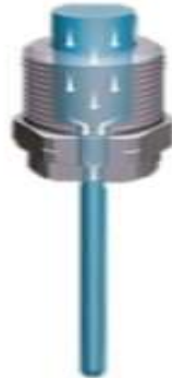
Figura 08 – Esquema do bico com orifício de formato padrão jato direto
