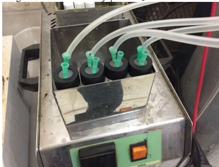
Figura 31 – Sistema de injeção de N 2 nos frascos vazios.
