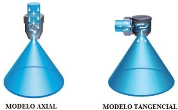
Figura 10 – Esquema do bico com padrão de dispersão cone cheio
