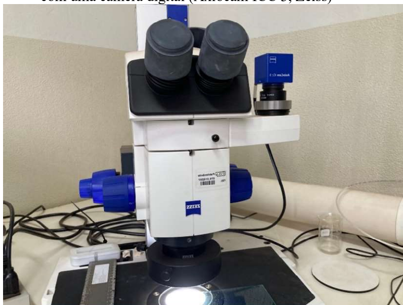
Figura 49 - Estereomicroscópio (Stereo Discovery V8, Zeiss, Jena, Alemanha) equipado com uma câmera digital (Axiocam ICC 3, Zeiss)
