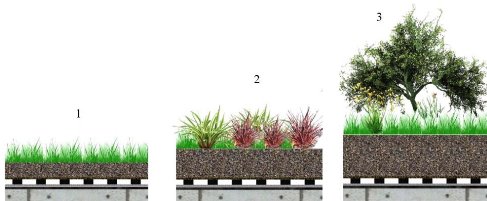
Figura 6: Esquema dos tetos verdes: 1- Extensivo, 2- Semi extensiva, 3- intensivo. Fonte: RAJI, TENPIERIK, VAN DEN DOBBELSTEEN (2015) adaptado
