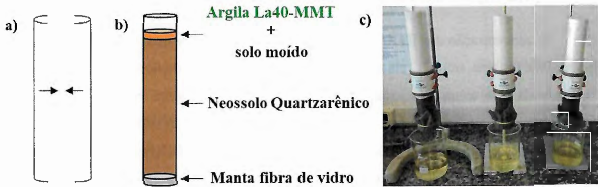
Figura 6. a) Ilustração da coluna bipartida; b) Ilustração do experimento destacando a mistura (solo moído + argila La40-MMT) inserida no topo da coluna preenchida com solo retido pela manta de fibra de vidro posicionada na extremidade inferior da coluna; c) experimento sendo realizado.
