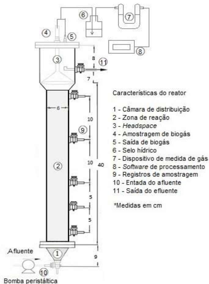
Figura 12 - Diagrama esquemático do reator UASB utilizado para processamento de vinhaça de cana-de-açúcar.
