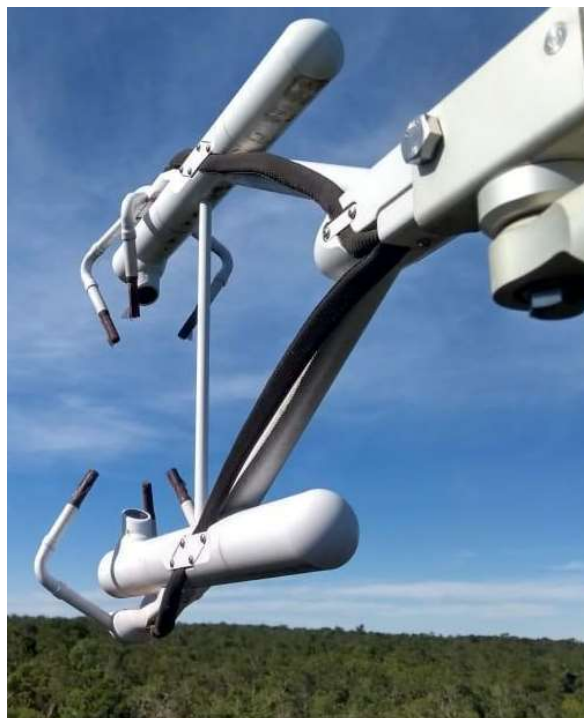
Figura 8. Analisador de gases ( H_2O e CO_2 ) de caminho aberto e anemômetro sônico 3D integrados (IRGASON® Campbell Scientific ).
