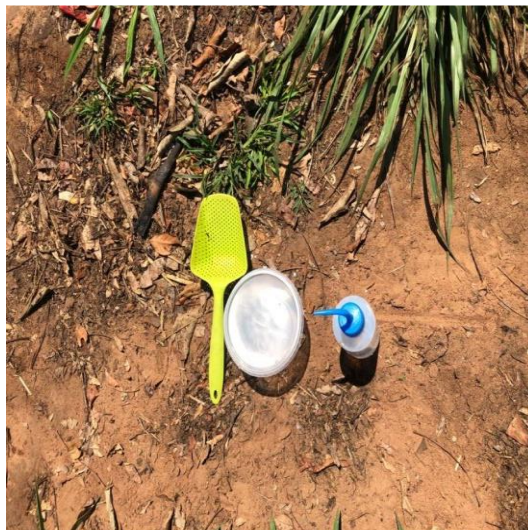
Figura 16 - Pá utilizada na coleta, pote plástico de 500 ml para armazenar sedimento e pisseta em polietileno para água 500 ml, com água deionizada para a limpeza das sondas do aparelho medidor de multiparâmetros
