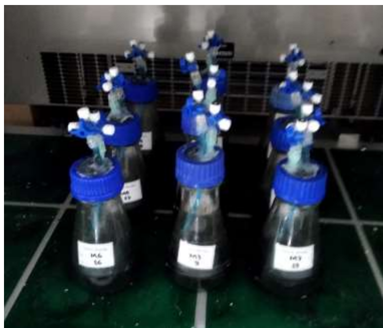
Figura B.1. Reatores batelada equipados com conjunto de válvulas acopladas.
