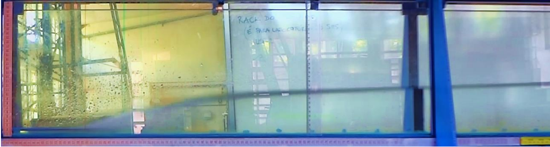
Experimento: CA-7. Vazão = 2,5 L/s. y_1 = 2,1 cm. y_2 = 11,0 cm. F_1 = 2,62 . Fundo liso, inclinado.
