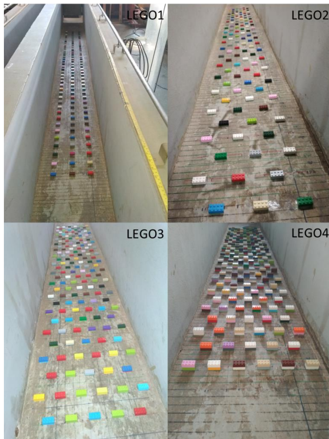
Figura 33. Imagens das 4 configurações elaboradas com peças Lego e placas base no canal B.
