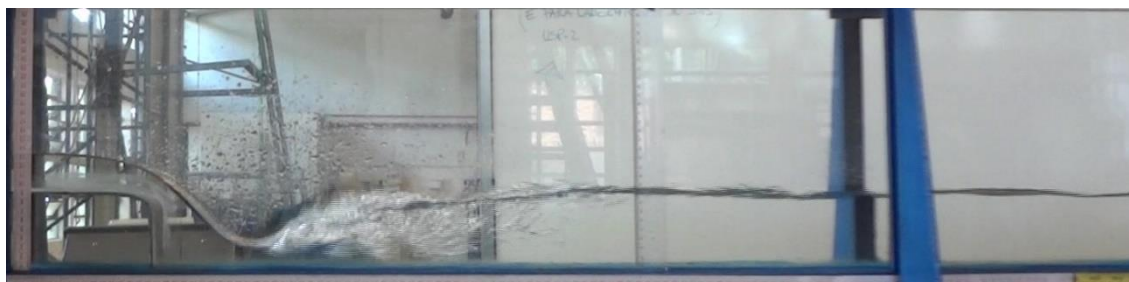
Experimento: SA-1. Vazão = 2,8 L/s. y_1 = 2,7 cm. y_2 = 9,1 cm. F_1 = 2,02 . Fundo liso, não inclinado.
