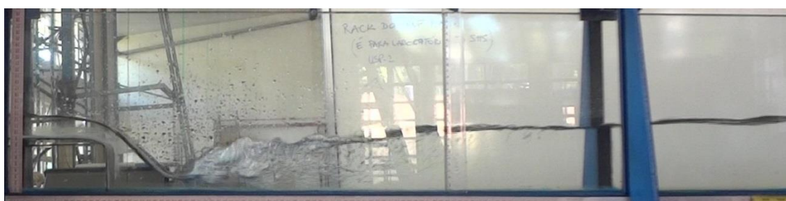
Experimento: SA-3. Vazão = 2,8 L/s. y_1 = 2,4 cm. y_2 = 11,0 cm. F_1 = 2,40 . Fundo liso, inclinado.
