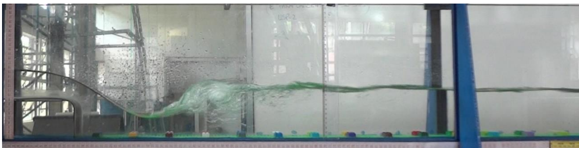
Experimento: SA-8. Vazão = 4,8 L/s. y_1 = 5,0 cm. y_2 = 11,0 cm. F_1 = 1,37 . Fundo rugoso, não inclinado.
