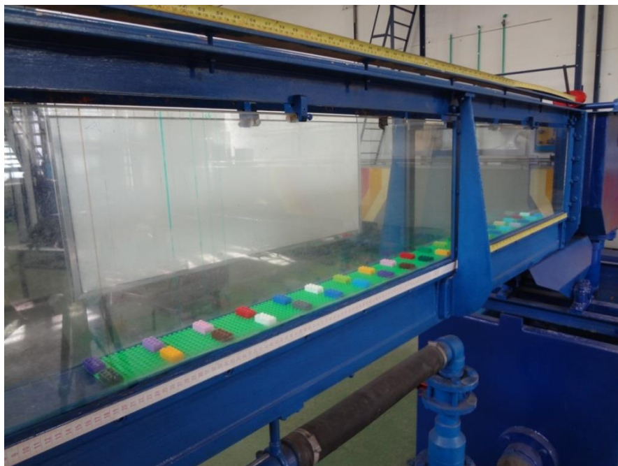
Figura 26. Arranjo com placas base e peças Lego em experimentos com vertedor, no canal A.
