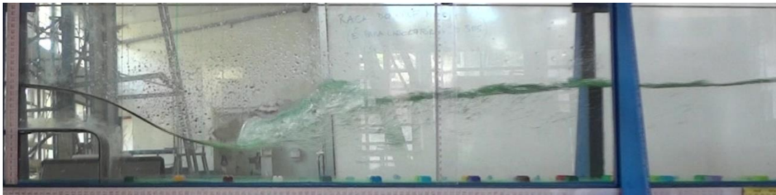
Experimento: SA-6. Vazão = 4,8 L/s. y_1 = 5,2 cm. y_2 = 15,4 cm. F_1 = 1,29 . Fundo rugoso, inclinado.
