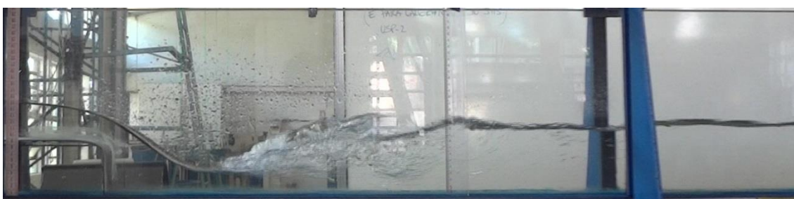
Experimento: SA-2. Vazão = 4,8 L/s. y_1 = 4,0 cm. y_2 = 11,2 cm. F_1 = 1,92 . Fundo liso, não inclinado.
