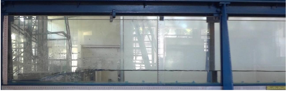
Experimento: CA-1. Vazão = 1,9 L/s. y_1 = 1,8 cm. y_2 = 6,7 cm. F_1 = 2,51 . Fundo liso, não inclinado.
