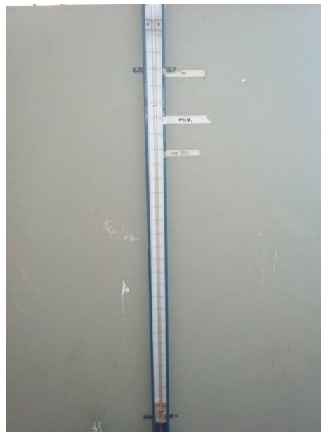
Figura 19. Piezômetro usado para medição da carga no vertedor triangular.
