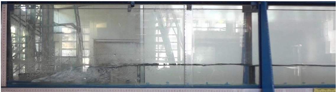
Experimento: CA-3. Vazão = 2,5 L/s. y_1 = 2,2 cm. y_2 = 8,1 cm. F_1 = 2,45 . Fundo liso, não inclinado.
