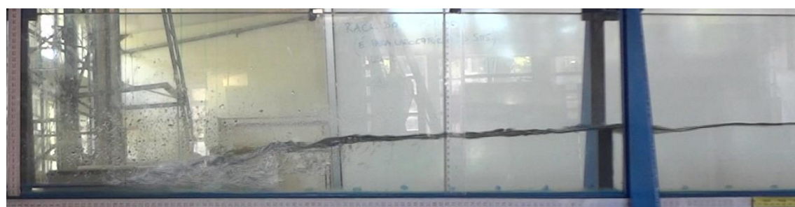
Experimento: CA-6. Vazão = 2,3 L/s. y_1 = 1,9 cm. y_2 = 10,0 cm. F_1 = 2,80 . Fundo liso, inclinado.
