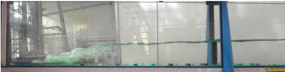
Experimento: CA-11. Vazão = 2,7 L/s. y_1 = 2,4 cm. y_2 = 10,9 cm. F_1 = 2,31 . Fundo rugoso, inclinado.
