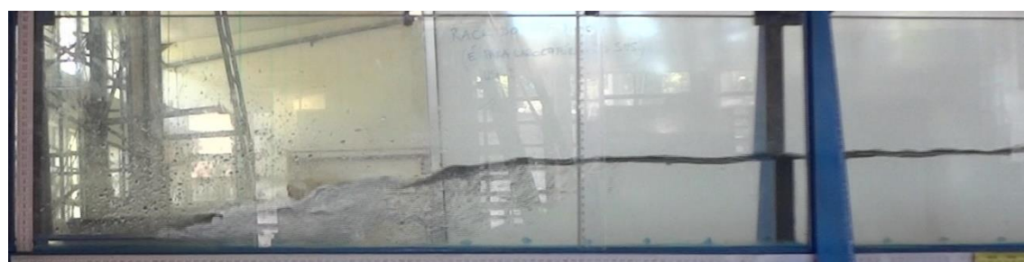
Experimento: CA-8. Vazão = 2,7 L/s. y_1 = 2,2 cm. y_2 = 11,5 cm. F_1 = 2,64 . Fundo liso, inclinado.
