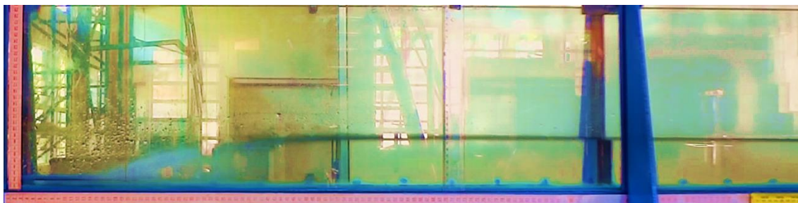
Experimento: CA-3. Vazão = 2,5 L/s. y_1 = 2,2 cm. y_2 = 8,1 cm. F_1 = 2,45 . Fundo liso, não inclinado.
