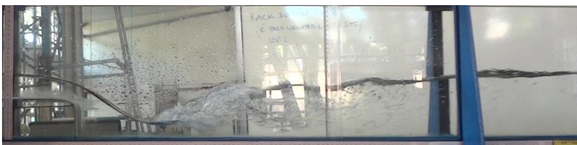
Experimento: SA-4. Vazão = 4,8 L/s. y_1 = 3,4 cm. y_2 = 14,4 cm. F_1 = 2,44 . Fundo liso, inclinado.
