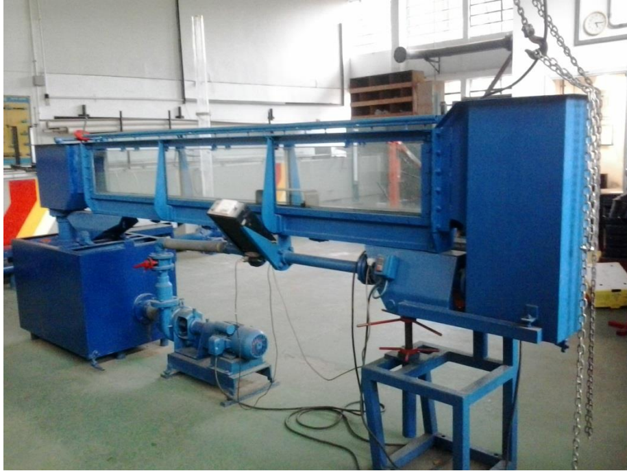
Figura 10. Canal A com laterais de vidro.
