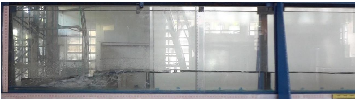
Experimento: CA-2. Vazão = 2,3 L/s. y_1 = 2,0 cm. y_2 = 7,4 cm. F_1 = 2,60 . Fundo liso, não inclinado.
