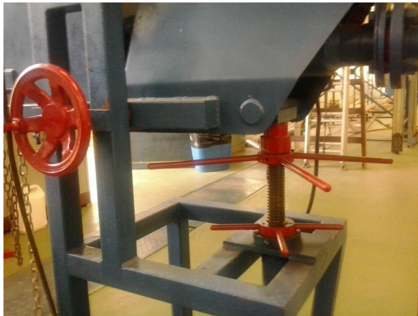
Figura 20. Regulador para controle manual da inclinação no canal.
