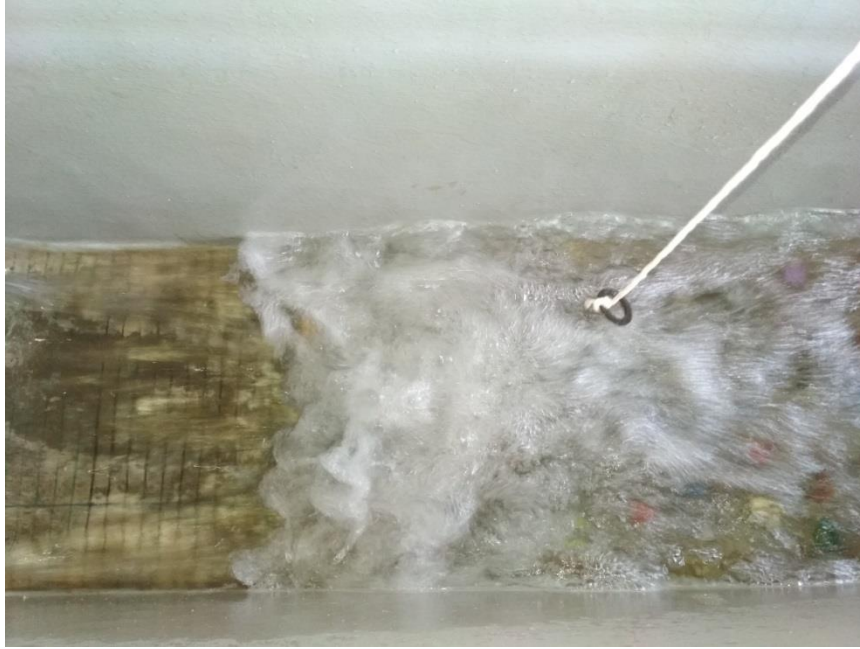
Figura 37. Barbante e anel de plástico usados para determinar a zona de estagnação da superfície livre.
