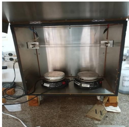
Figura 13: Câmara escura do colimador pelo lado interno com lâmpada posicionada sem o focalizador do feixe, com dois agitadores magnéticos dentro, do mesmo modelo que foi utilizado neste teste.
