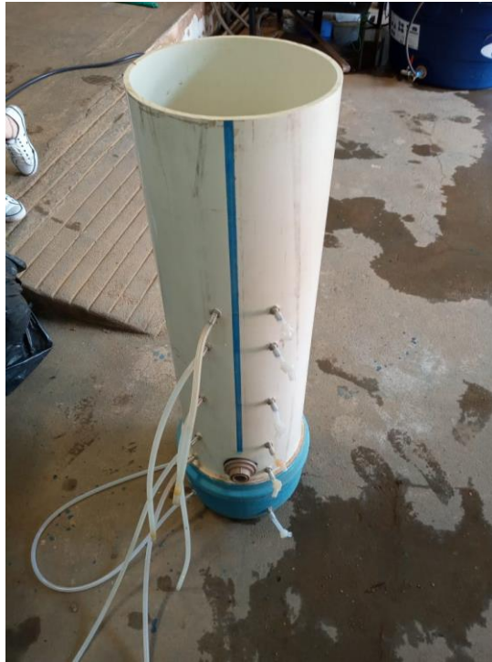
Figura 7: Corpo do filtro confeccionado em PVC com piezômetros já instalados.
