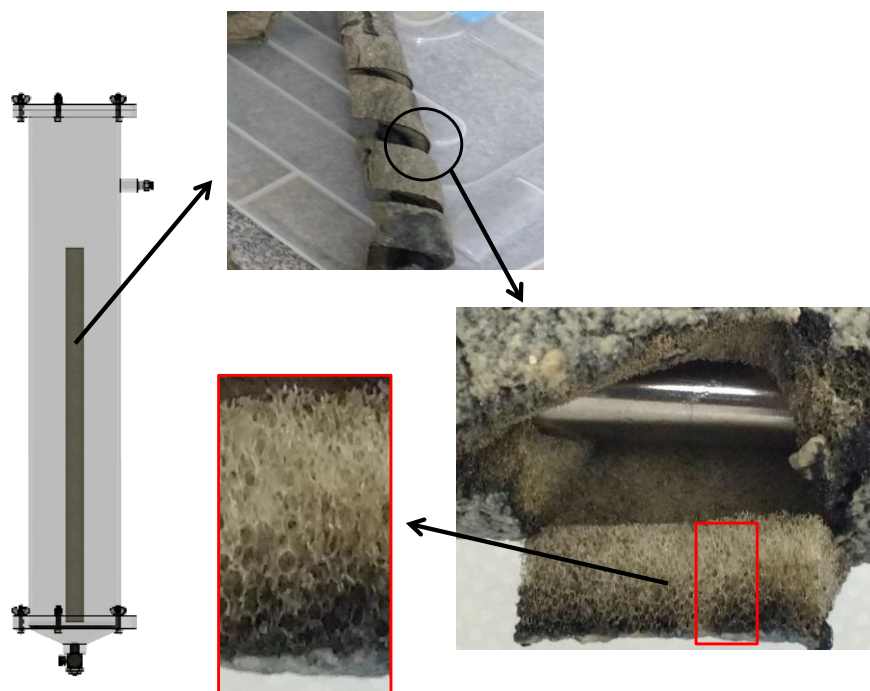
Figura 31- Detalhamento da retirada de amostra de espuma de poliuretano utilizada como meio suporte nos reatores estudados para análise por microscopia eletrônica de varredura
