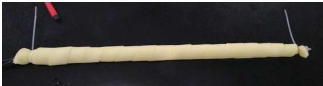
Figura 6- Detalhe da espuma de poliuretano enrolada na resistência elétrica
