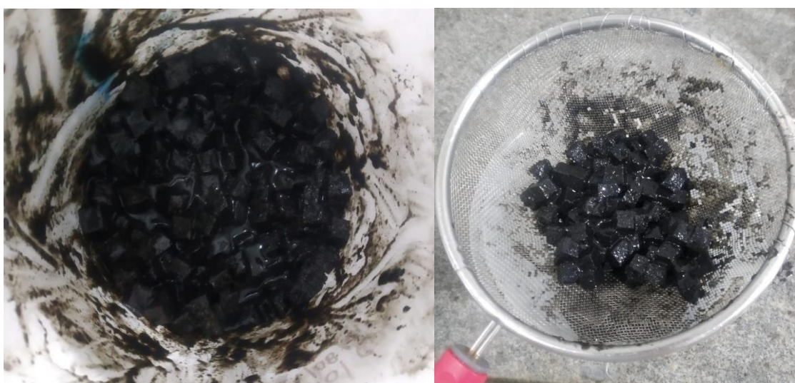
Figura 5 - Biomassa imobilizada em espuma cúbica de poliuretano com 1,0 cm de aresta.
