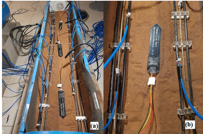
Figura 18 – Posicionamento dos sensores de umidade e dos termopares no experimento de abordagem DPHP-DTS: (a) visão geral e (b) detalhe
