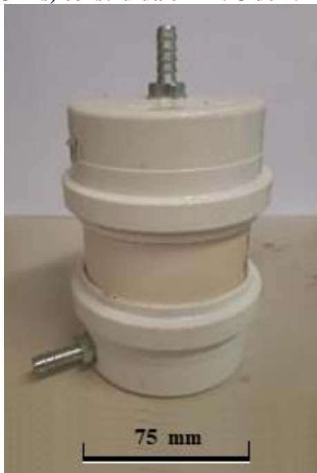
Figura 4. 9 - Célula de fluxo (CFXs) construída em PVC de 75 mm de diâmetro.
