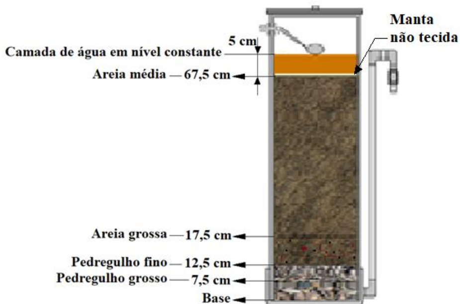
Figura 4.3 - Medidas das camadas que constituem o leito filtrante dos FLDs.
