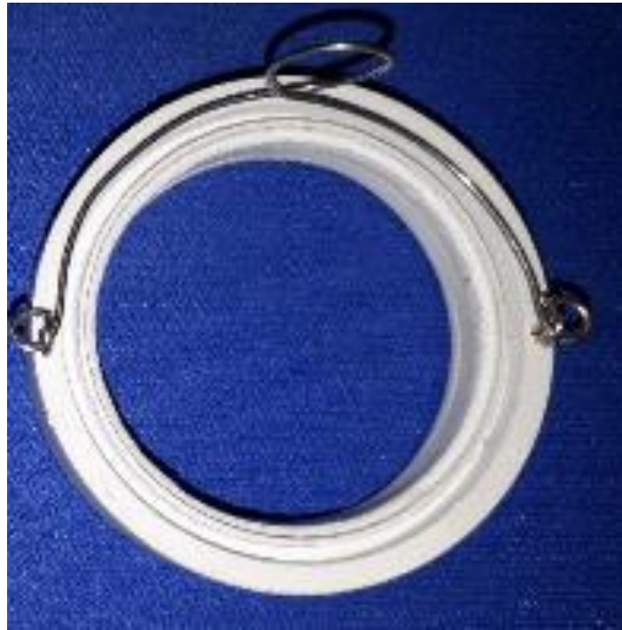
Figura 4. 16 - Detalhe da alça em aço inoxidável que facilita a remoção para análises.
