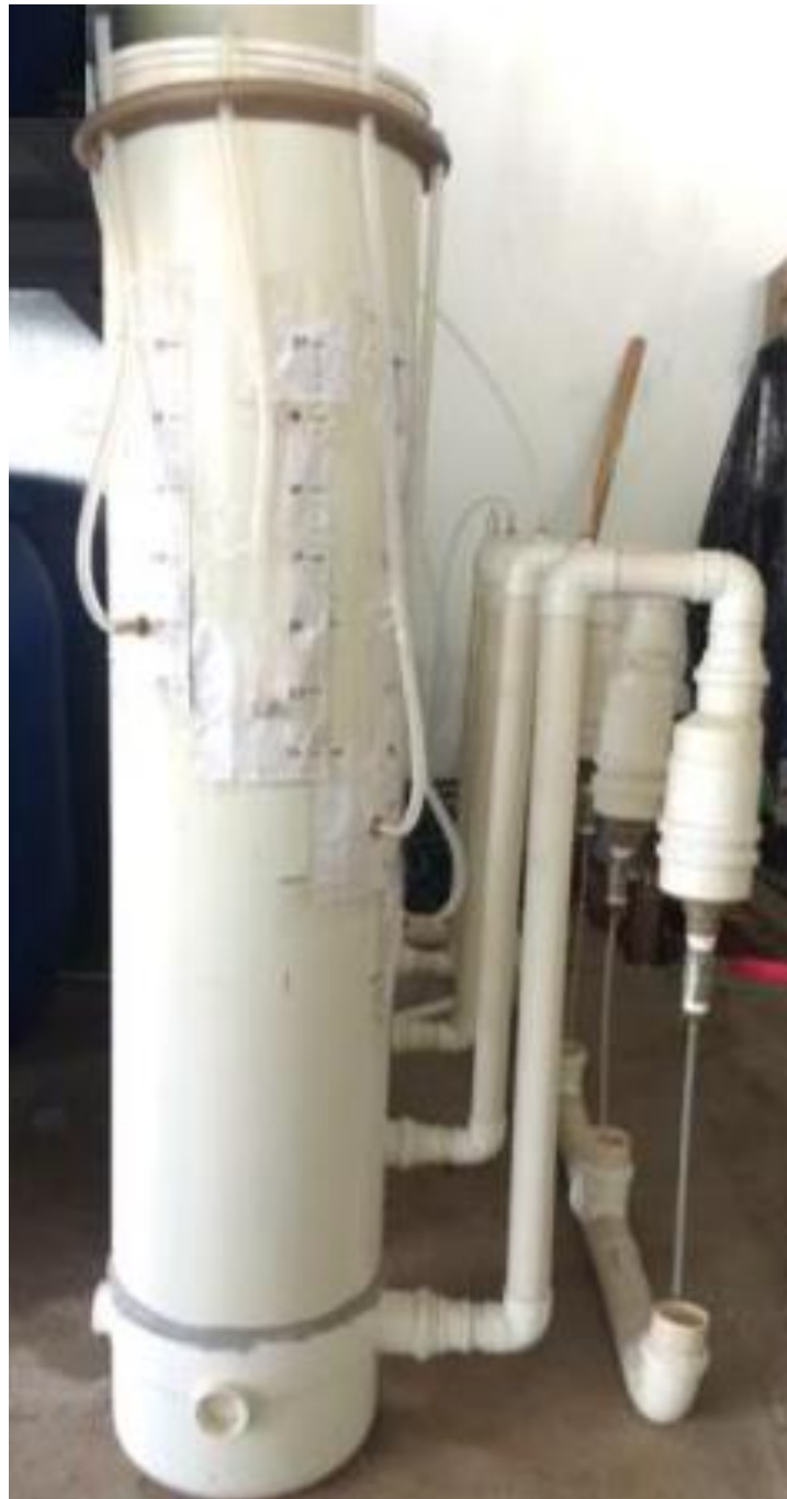
Figura 3.3 - Estrutura do filtro lento em areia em escala domiciliar proposto por Freitas (2017).
