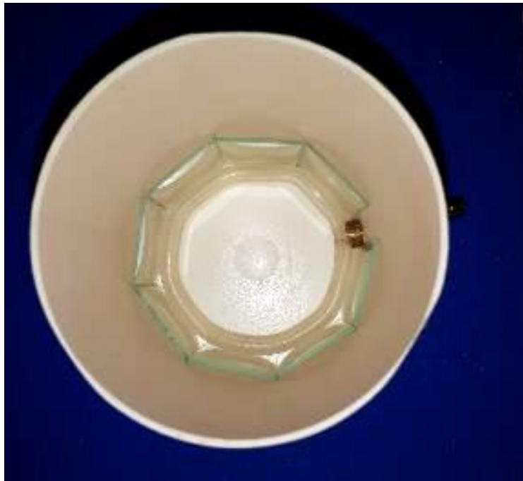
Figura 4. 13 - Foto de CFX aberta contendo 8 lâminas de vidro e anel feito em mangueira de silicone para fixação no fundo.
