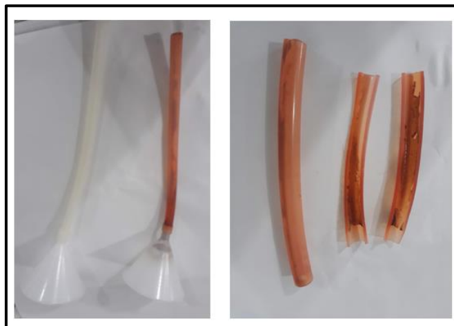
Figura 5.5 - Mangueira de silicone acoplada na saída o R1.1, antes e depois de 90 dias de operação
