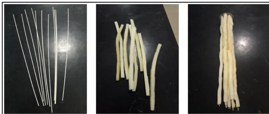
Figura 4.3- Montagem do leito fixo estruturado de espuma de poliuretano
