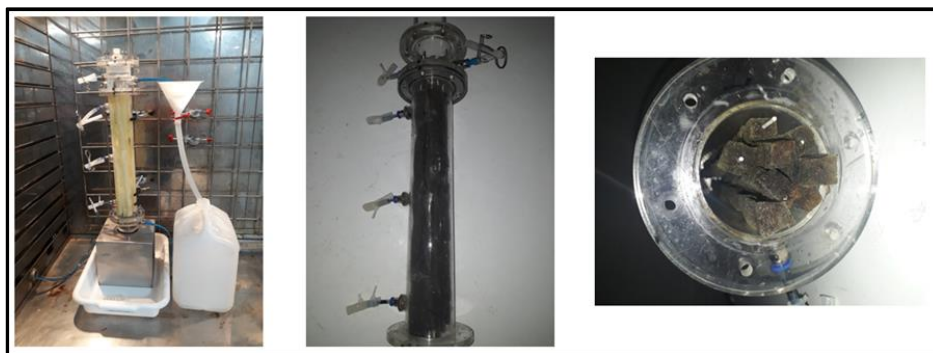
Figura 5.3 - Leito estruturado antes e após o período de adaptação do lodo aeróbio
