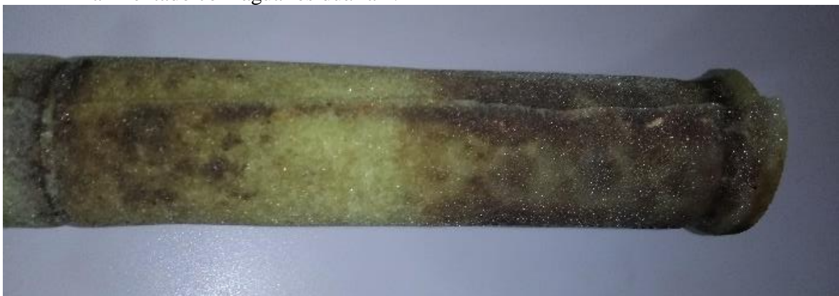
Figura 5.8 – Espuma de poliuretano com baixa adesão de sólidos ao final da operação do R – 2 mm alimentado com água residuária 1.
