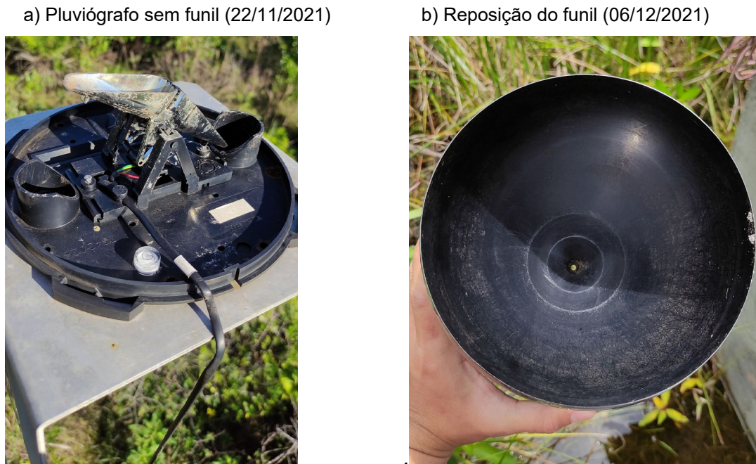
Figura 38 – Identificação da perda do funil do pluviógrafo após inspeção de campo realizada em 22 de novembro de 2021
