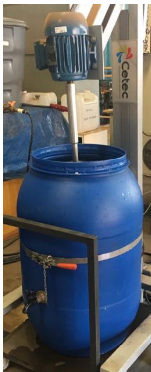
Figura 6- Misturador mecânico usado para homogeneização da água em bombona de 200 litros.
