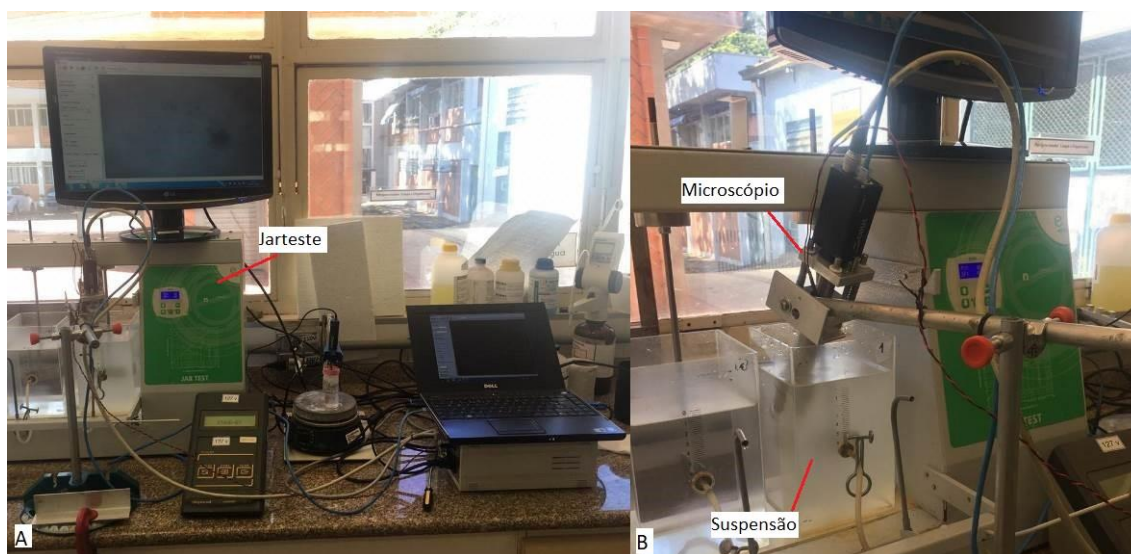
Figura 10 – Arranjo experimental para aquisição de imagens por meio da microscopia in situ .
