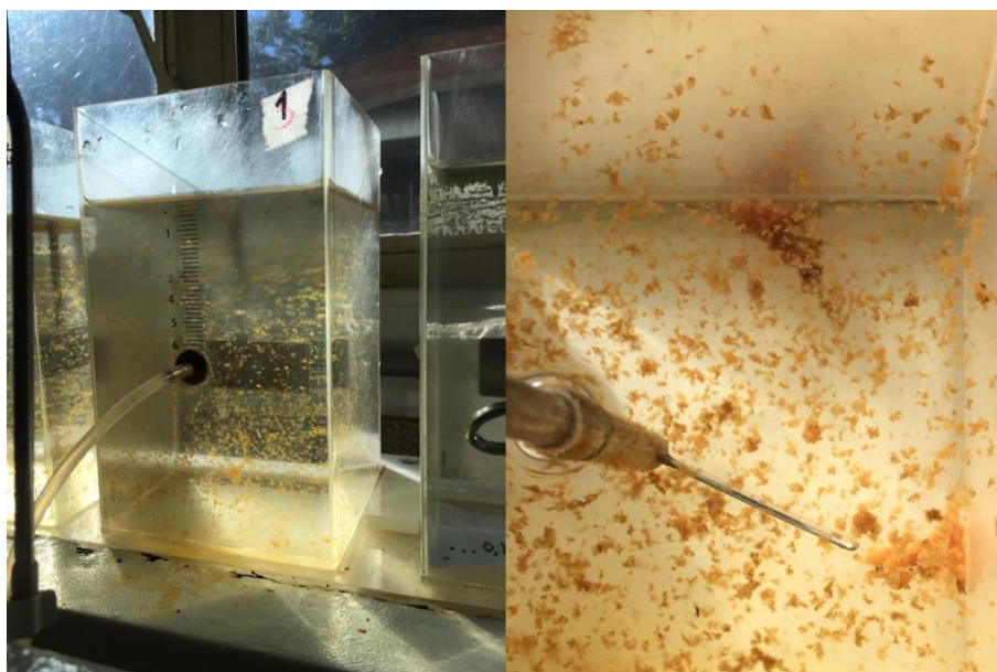
Figura 35 - Flocos formados no tratamento da água natural com cloreto férrico.
