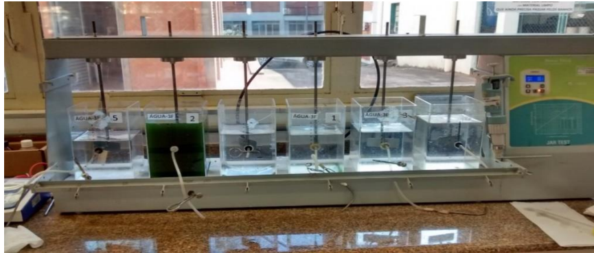
Figura 8 - Jartest do Laboratório de Tratamento Avançado de Águas Residuária (Latar)
