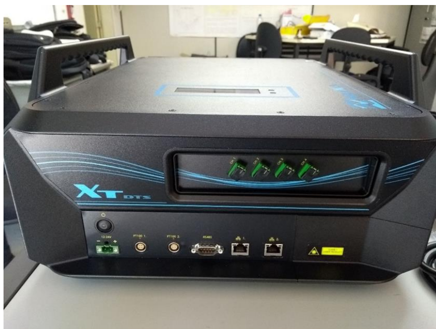
Figura 13 - Dispositivo DTS utilizado, em ambiente de laboratório e aplicado na área de estudo
