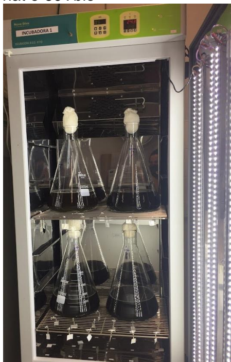
Figura 3.5 – Incubadora (Nova Ética B.O.D 411D), adaptada com iluminação à LED (Light Emitting Diode), com as 4 amostras do Experimento III, realizado em triplicata por um período de 10 dias para as microalgas Chlorella sorokiniana e Chlorella vulgaris nas condições de 40Vnat e 60Vbio
