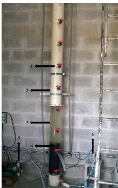
Figura 4.4 - Reator EGSB em escala aumentada: (1) Pontos de amostragem (12 Pontos), (2) Parte em PVC (3,1 m), (3) Parte em acrílico (1 m), (4) Lodo adensado, (5) Bomba de recirculação do efluente (diafragma) e (6) Bomba de alimentação (diafragma).
