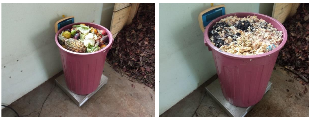
Figura 22 – Determinação da densidade aparente pelo método do balde.
