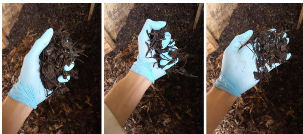
Figura 29 – Execução do teste rápido para verificar nível de umidade.
