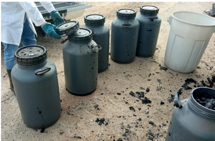
Figura 23 – Detalhe do uso das bombonas de leite na coleta de lodo na ETE.
