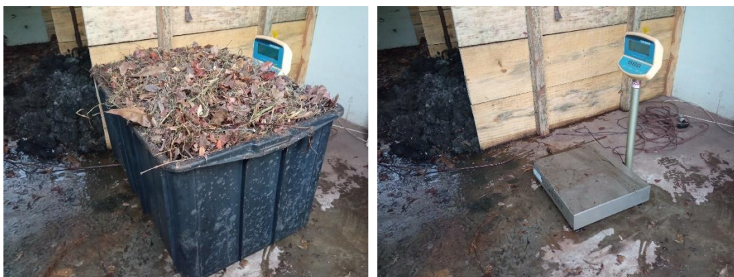
Figura 17 – Pesagem das porções de resíduos adicionadas às camadas de montagem das leiras.
