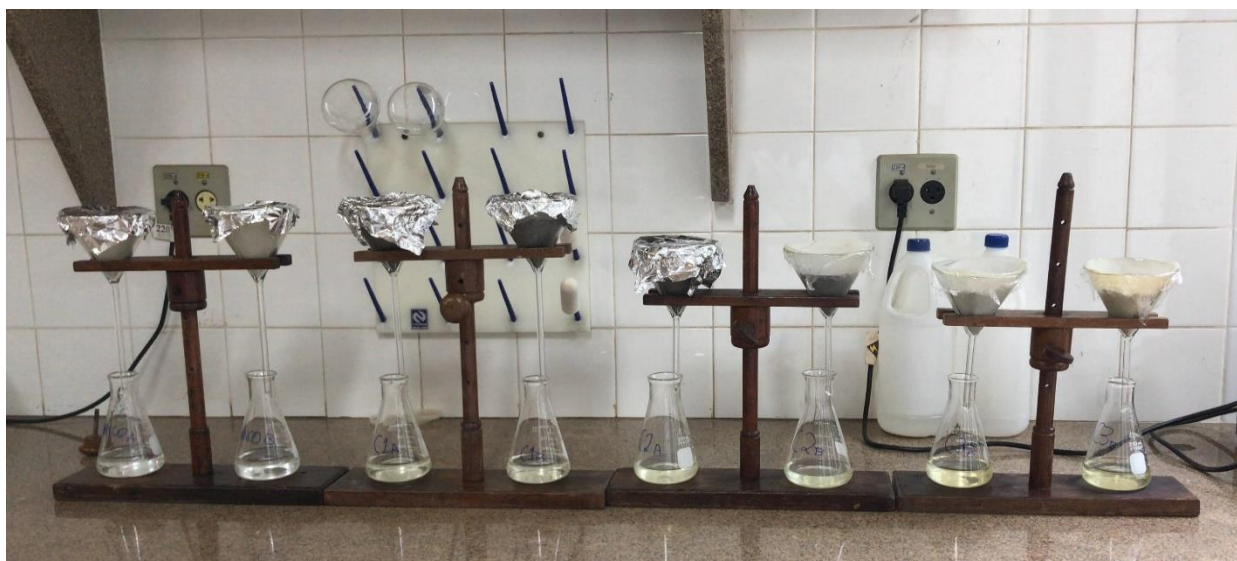
Figura 21 – Aparato para determinação da capacidade de retenção de água – CRA.
