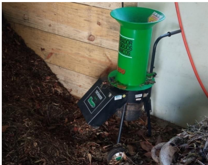
Figura 12 - Triturador Trapp modelo TR200 com 1,5 cv de potência.
