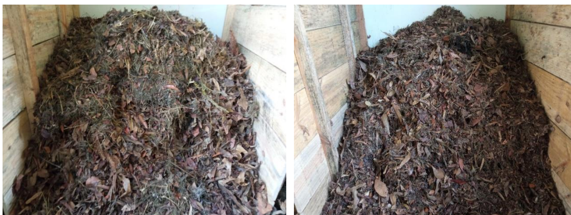
Figura 24 – Resíduos de poda e capina antes e depois do processo de trituração.
