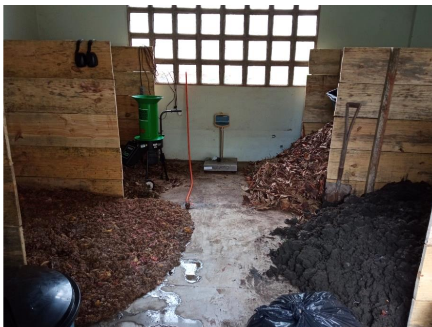
Figura 13 – Armazenagem de resíduos triturados pré-montagem das leiras.
