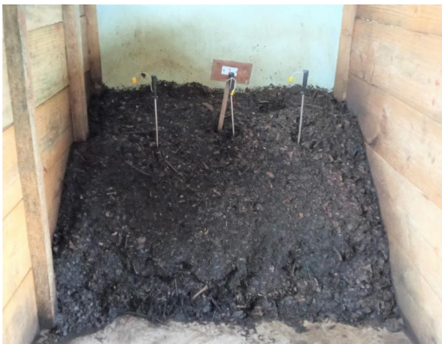
Figura 20 – Posicionamento dos sensores de temperatura na leira.
