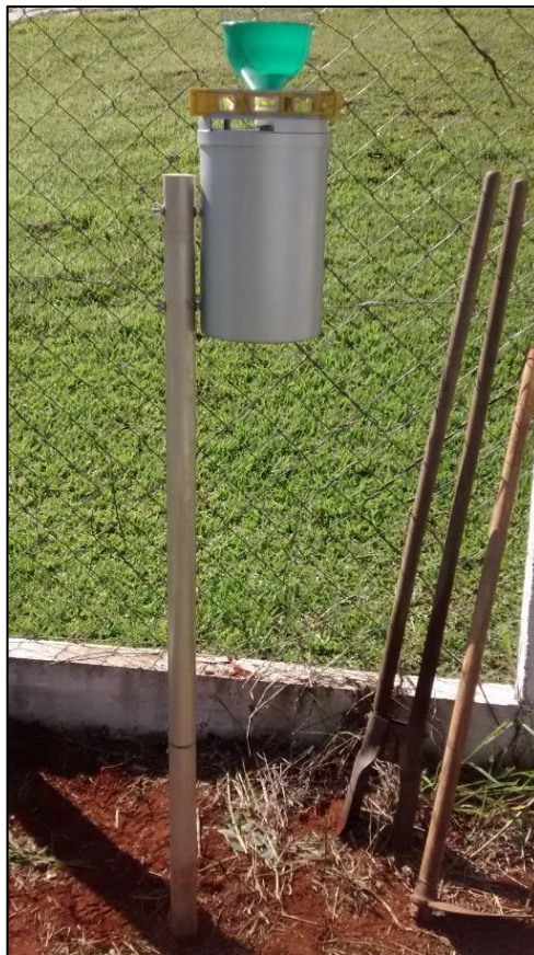
Figura V-2. Coletor de chuvas (Palmex®) instalado para estudo envolvendo isótopos estáveis da água.
