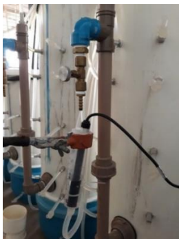
Figura 7 – Compartimento para disposição da sonda de condutividade durante o ensaio hidrodinâmico
