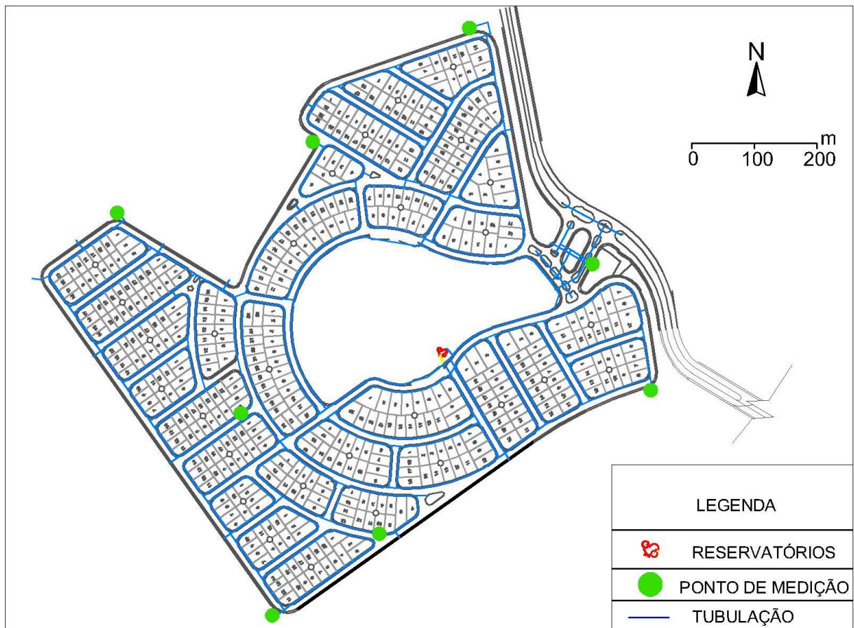
Figura 11 - Planta de monitoramento de sensores de pressão.
