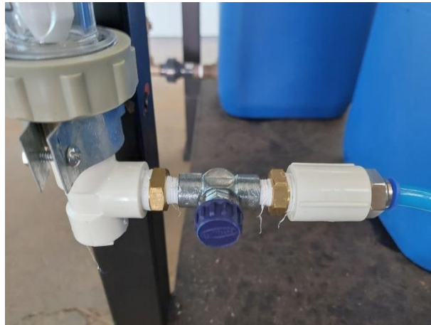
Figura 5.3. Detalhe da válvula de agulha para ajuste fino da vazão
