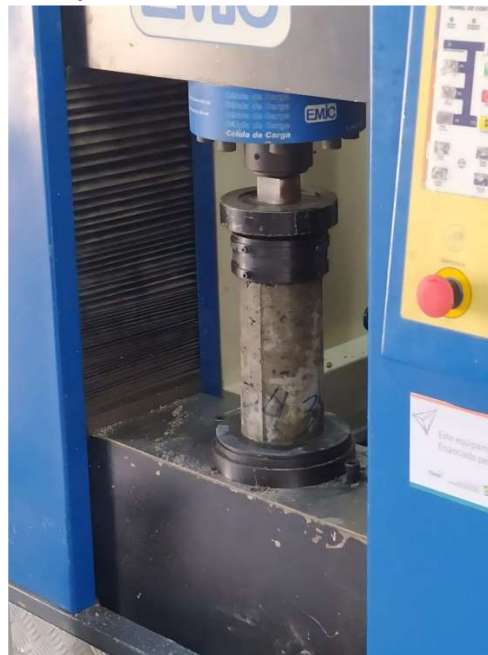
Figura 22: Corpo de prova no momento do ensaio de compressão
