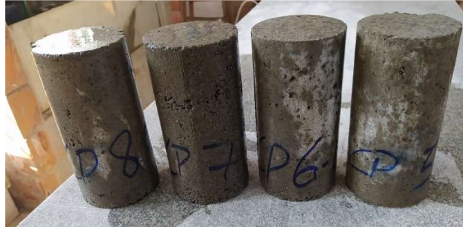
Figura 21: Corpos de provas cilíndricos, logo após a retificação.
