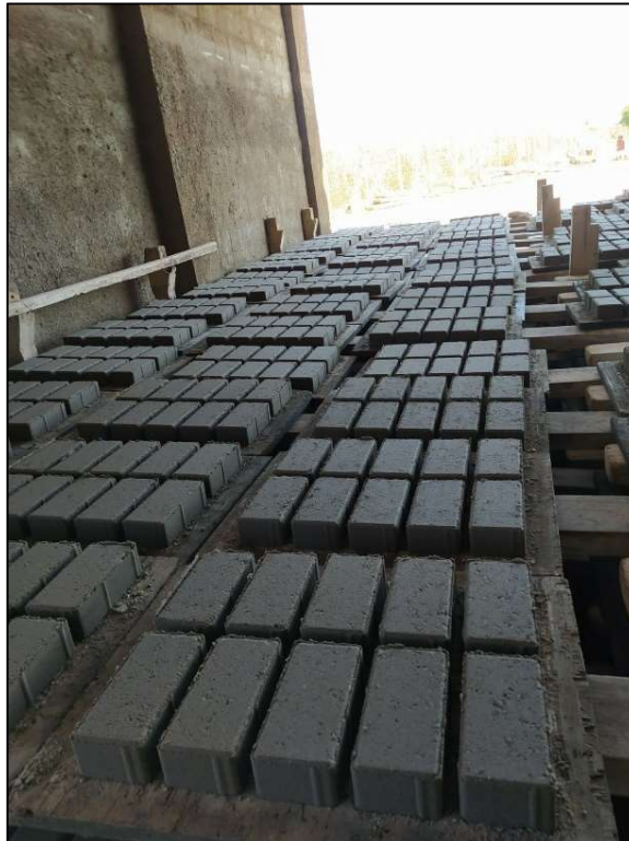
Figura 25: Pátio coberto onde os pavos são armazenados para cura inicial
