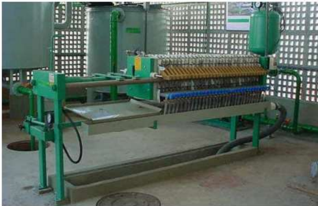
Figura 4: Filtro prensa de desidratação de lodo.
