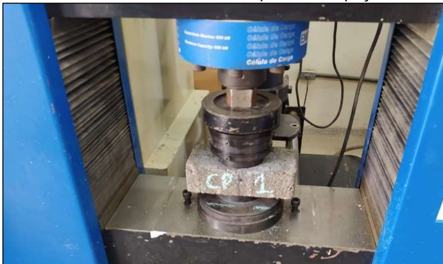
Figura 27: Ensaio de resistência a compressão na peça de concreto
