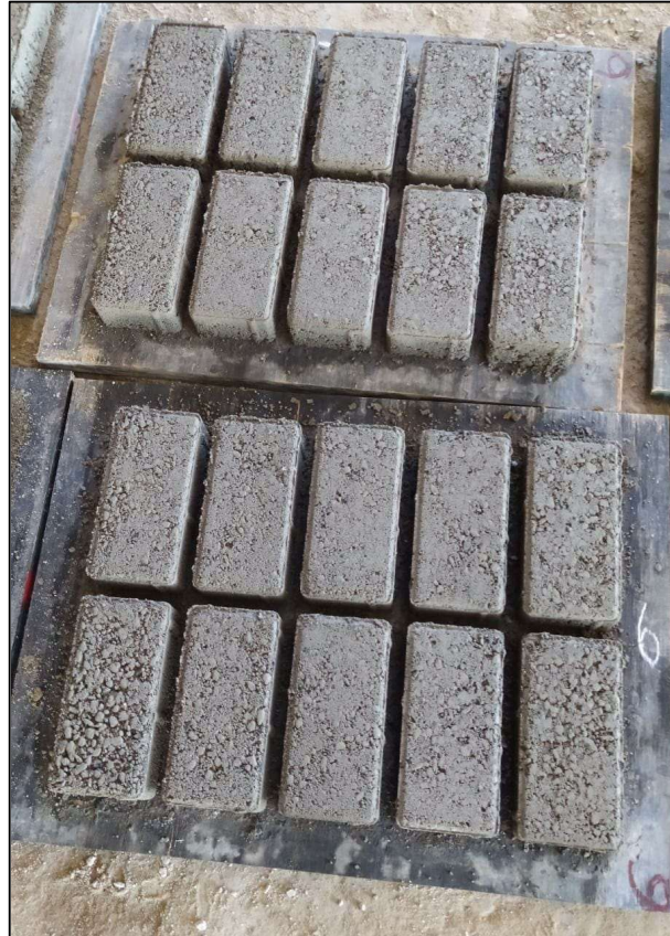
Figura 26: Peças de concreto com 6% de teor de substituição após confecção
