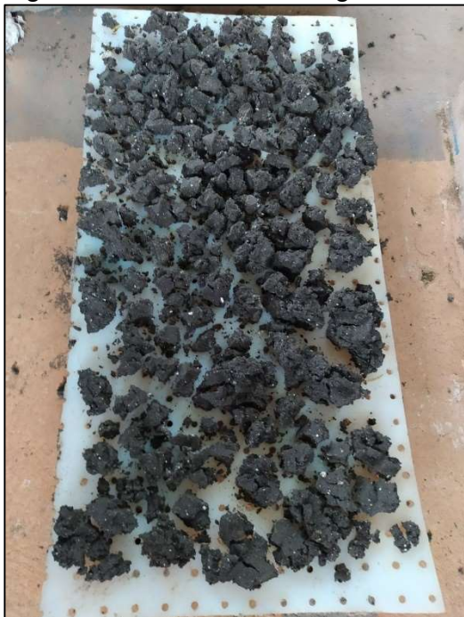
Figura 17: 13° dia de secagem
