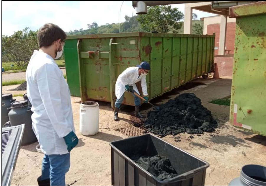
Figura 10: Coleta do lodo da ETE logo após centrifugação
