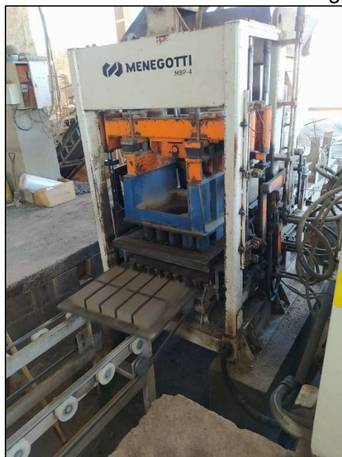
Figura 11: Vibro Prensa no momento da moldagem das peças
