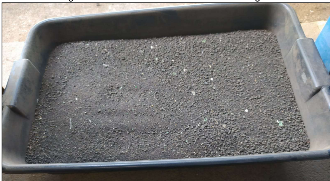
Figura 19: Lodo triturado ao 15° dia de secagem
