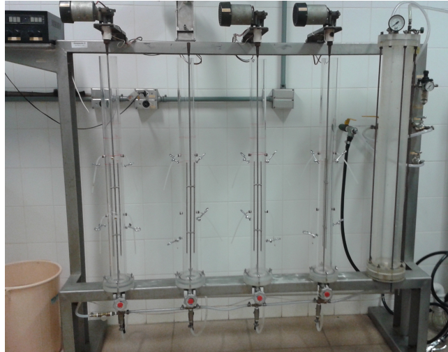
Figura 4 - Equipamento de bancada (Flotateste) para os ensaios de flotação por ar dissolvido
