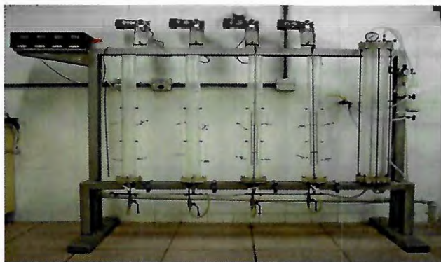
Figura 4. 7 - Equipamento utilizado para flotação por ar dissolvido.
