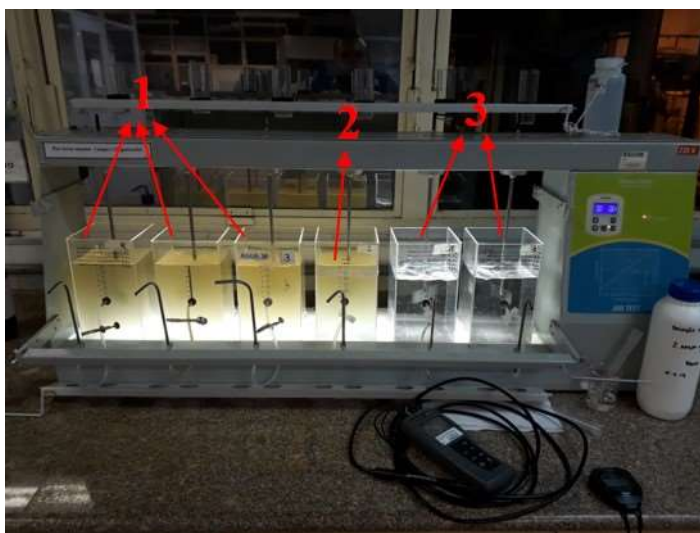
Figura 25 - Jarrest preparado para um ciclo de testes em escala de bancada: 1- Amostras, 2- Branco e 3- Água para equilibrar o equipamento.
