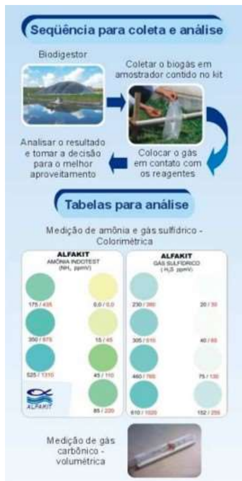
Figura 23 – Sequência dos procedimentos para coleta e análise do biogás.
