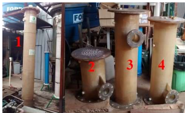
Figura 10 - Partes do RAANA piloto confeccionadas em plástico reforçado com fibra de vidro: 1- Zona anaeróbia, 2- Zona aeróbia, 3- Zona nitrificante e 4- Zona anóxica.
