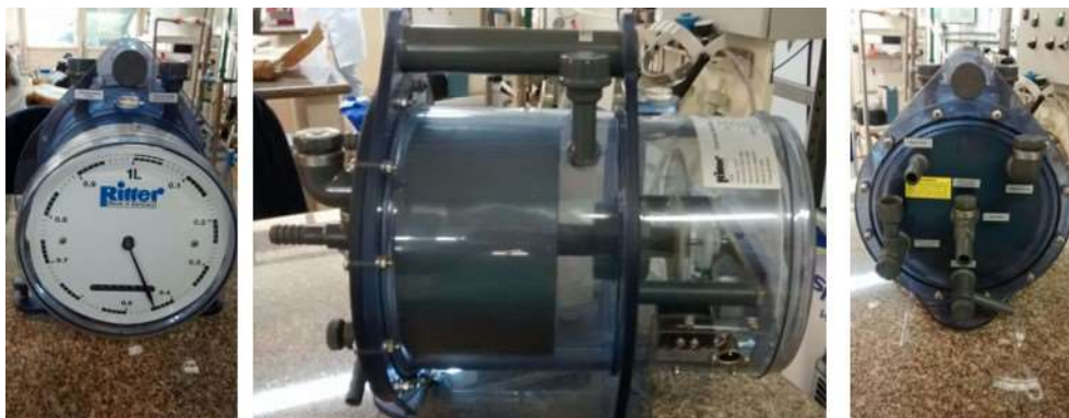
Figura 24 - Medidor de vazão do biogás coletado na zona anaeróbia do RAANA piloto.
