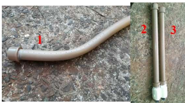
Figura 16 - Difusores: 1- Difusor de ar da zona aeróbia, 2- Difusor de ar da zona nitrificante e 3- Difusor do biogás recirculado na zona anóxica.
