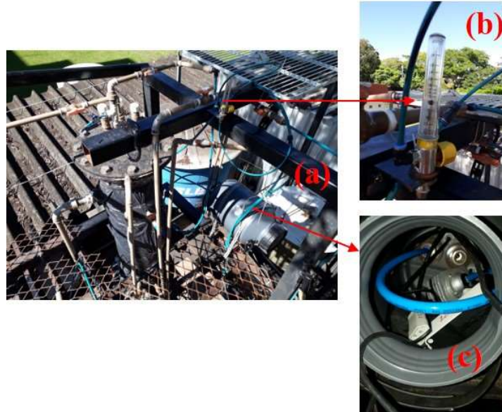
Figura 18 – Sistema de recirculação do biogás na zona anóxica: (a) Vasilhame de plástico hermeticamente fechado, (b) Rotâmetro para aferição da vazão de recirculação e (c) Compressor instalado dentro do vasilhame.
