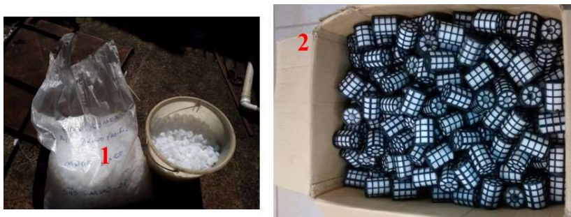
Figura 17 – Meios suporte utilizados no RAANA piloto: 1- Meios suporte PZE500 e 2- Meios suporte Biobob ® .
