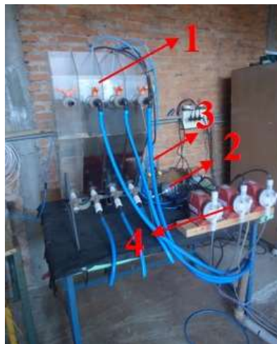
Figura 4 – Instalação experimental do sistema MBBR em escala de bancada: (1) Reatores MBBR montados em paralelo, (2) Sopradores, (3) Rotâmetros e (4) Bombas dosadoras de diafragma.
