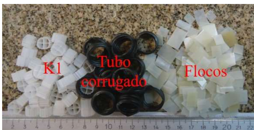
Figura 5 – Meios suporte avaliados nos reatores MBBR em escala de bancada, da esquerda para direita, K1 Anox Kaldnes, tubo corrugado e flocos de PEAD.
