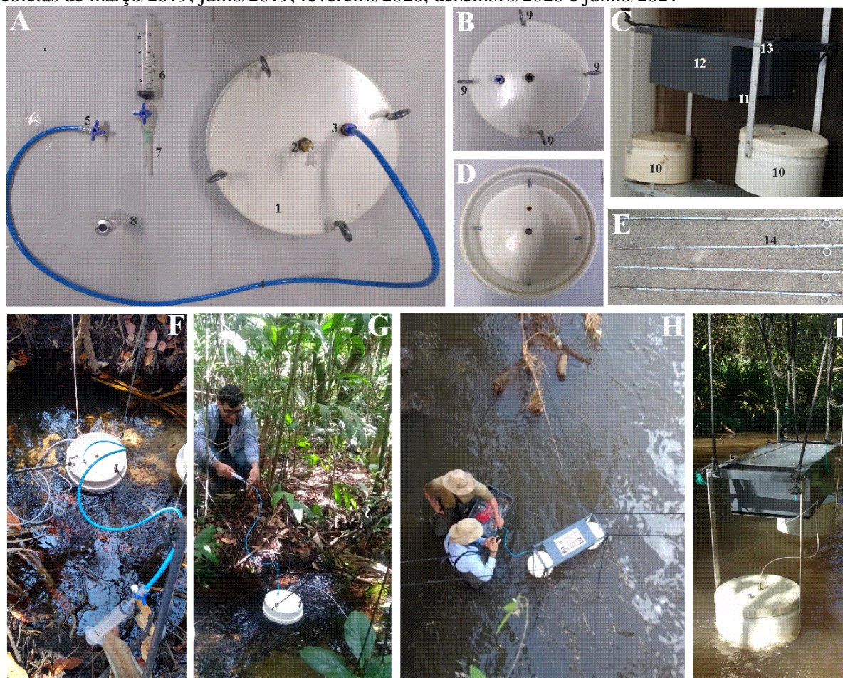
Figura 2.1 - Fotos e descrição dos componentes da câmara flutuante convencional (CF) confeccionada, bem como da sua utilização nos cursos de água de maior e menor porte para a estimativa das emissões de dióxido de carbono (CO 2 ) e metano (CH 4 ) pelos trechos estudados nas coletas de março/2019, julho/2019, fevereiro/2020, dezembro/2020 e junho/2021
