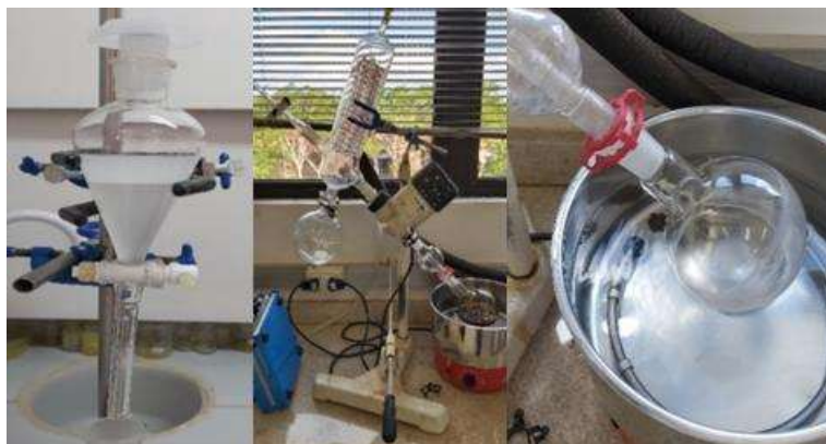
Figura 18 – (a) Extração e separação de fases, em funil de separação, pela adição do solvente extrator na amostra contendo lipídeos; (b) evaporação do solvente extrator, na fase de interesse, em rotaevaporador e (c) obtenção do concentrado para análise cromatográfica.
