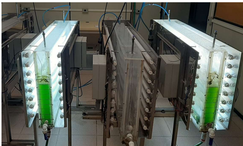
Figura 04 – Fotobiorreatores “ Flat Panel ” contendo as microalgas adaptadas ao esgoto sanitário bruto
