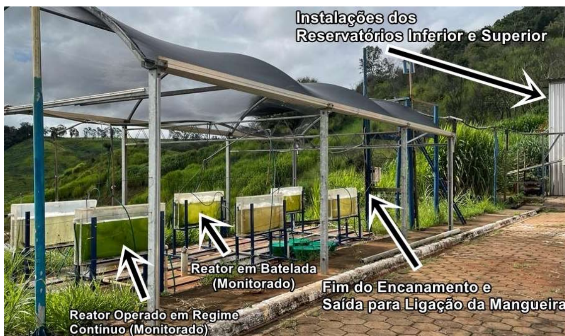
Figura 08 – Instalações experimentais utilizadas durante o cultivo de microalgas em condições locais de temperatura e luminosidade
