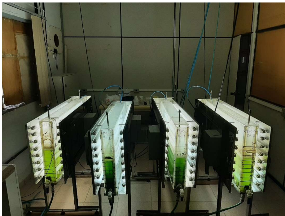
Figura 05 – Reatores “Flat Panel” durante as diferentes condições de cultivo testadas em laboratório
