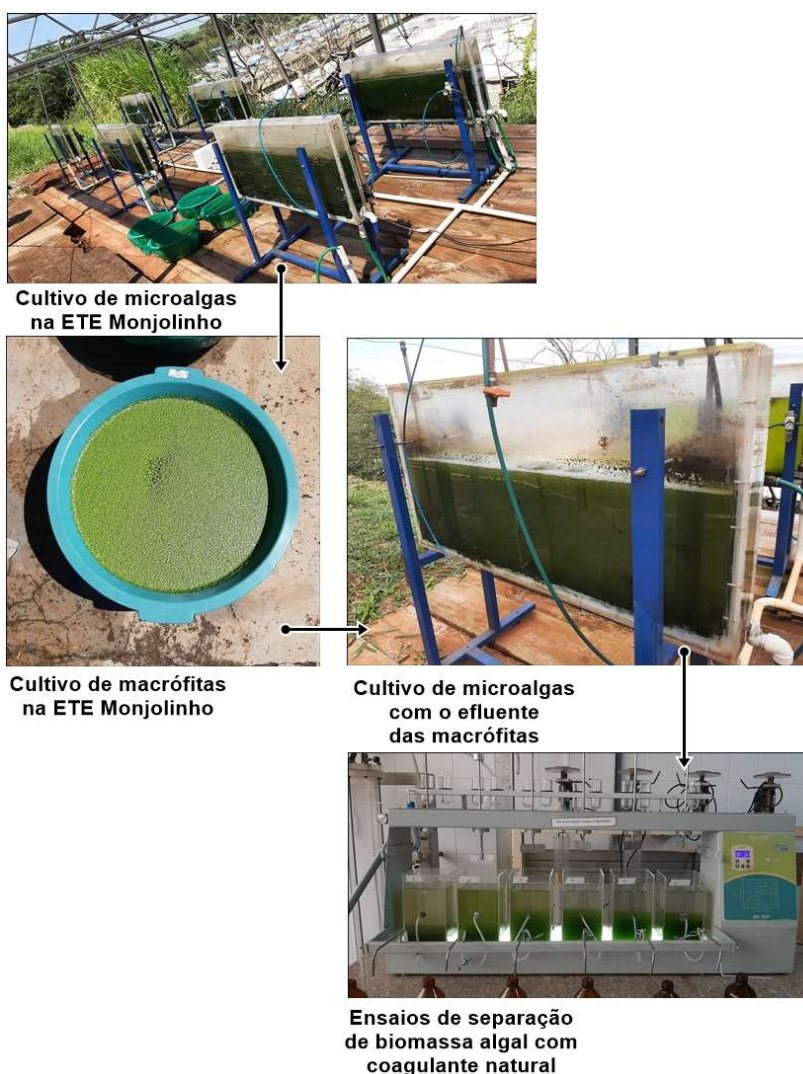
Figura 02 – Etapas dos experimentos de cultivo de macrófitas e microalgas em condições locais de temperatura e luminosidade
