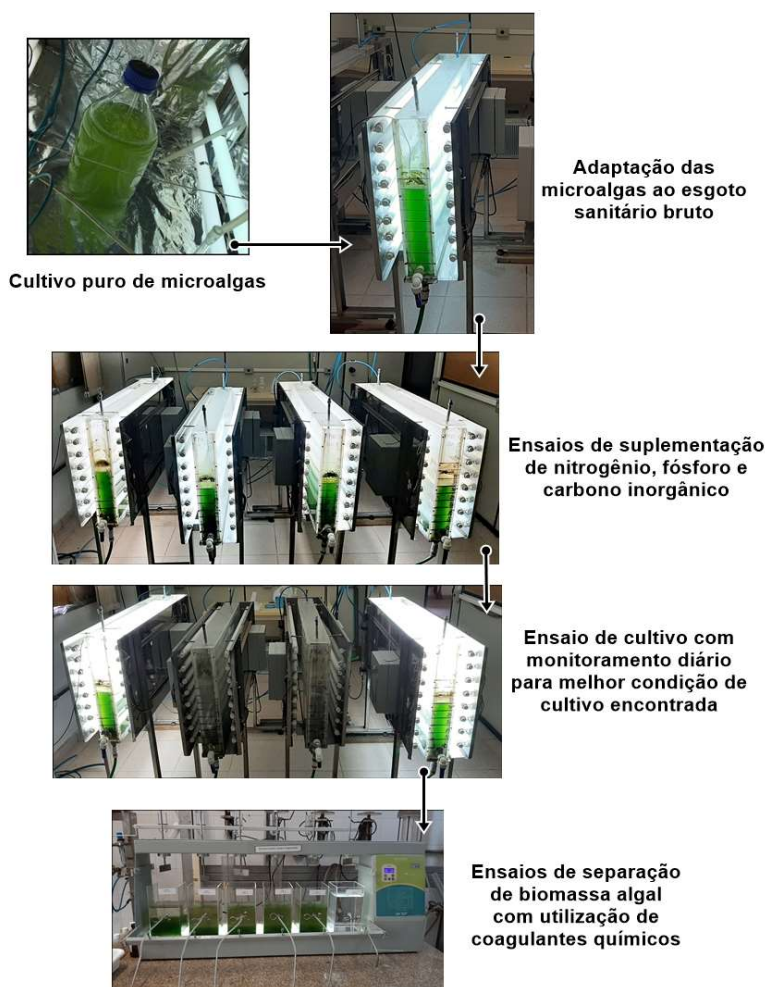
Figura 01 – Etapas dos experimentos de cultivo e separação de microalgas feitos em laboratório
