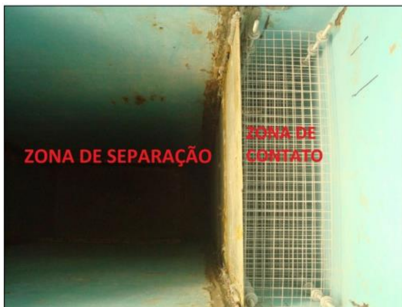
Figura 6 – Imagem dos módulos de telas de aço galvanizado modelo Hobby incorporados ao interior da zona de contato da UPFAD por Meca (2014).
