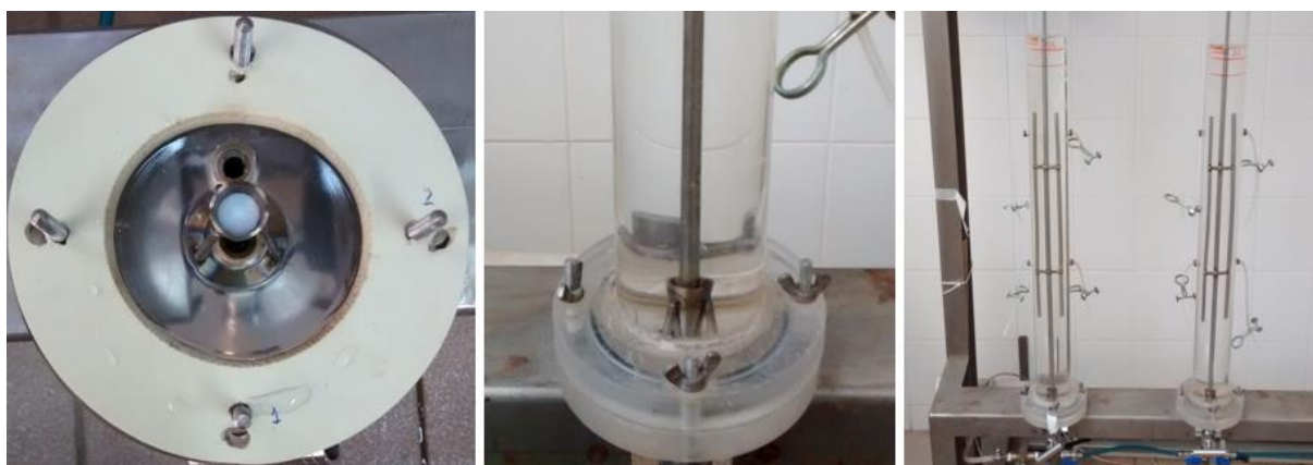
Figura 11 – Detalhes da instalação do dispositivo de amparo na base das colunas de flotação do Flotateste.
