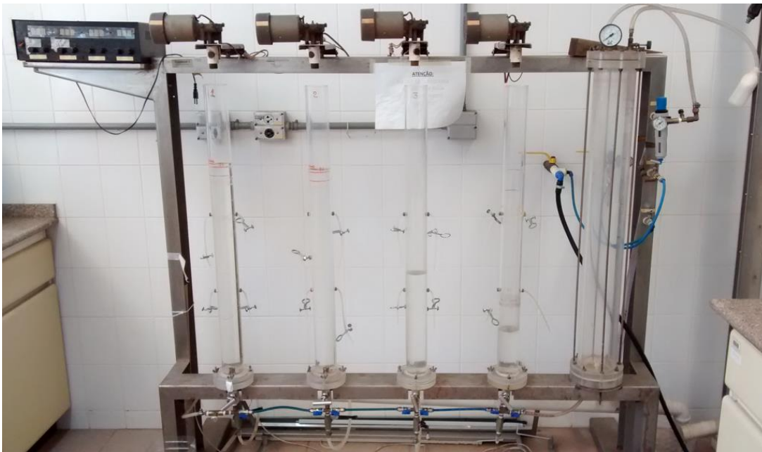
Figura 9 – Imagem do Flotateste utilizado para a execução dos ensaios propostos.
