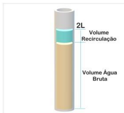
Figura 12 – Representação esquemática de coluna de flotação do Flotateste e dos volumes de água bruta e de recirculação.
