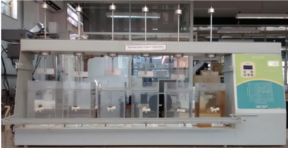
Figura 7 – Unidade de equipamento Jartest empregado para a imposição do processo de coagulação.
