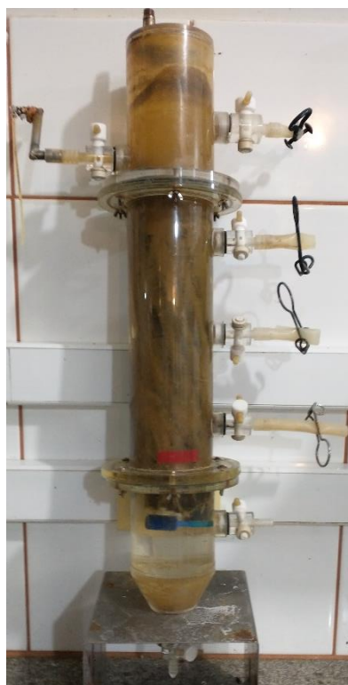
Figura 4.2. Imagem do reator anóxico e a biomassa aderida em espuma de poliuretano após os 100 dias de operação
