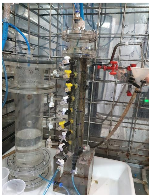
Figura 4.3. Imagem do reator aeróbio e a biomassa aderida em espuma de poliuretano após os 480 dias de operação
