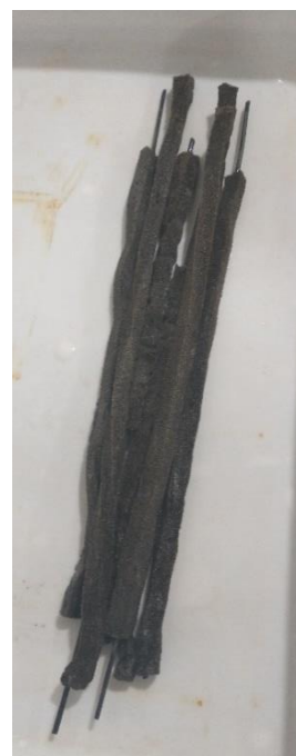
Figura 4.3. Imagem do reator aeróbio e a biomassa aderida em espuma de poliuretano após os 480 dias de operação
