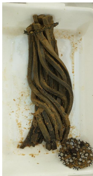
Figura 4.2. Imagem do reator anóxico e a biomassa aderida em espuma de poliuretano após os 100 dias de operação
