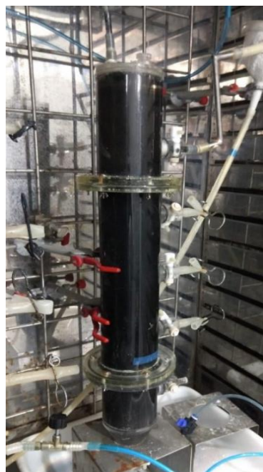
Figura 4.1. Imagem do reator anaeróbio e a biomassa aderida em espuma de poliuretano após os 580 dias de operação
