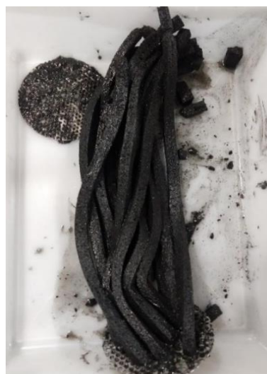
Figura 4.1. Imagem do reator anaeróbio e a biomassa aderida em espuma de poliuretano após os 580 dias de operação
