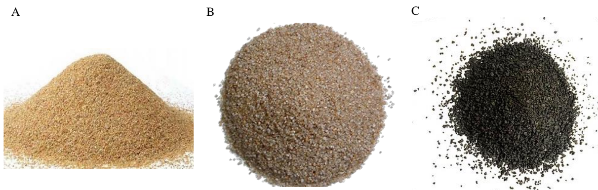
Figura 7 – Exemplos de (A) areia fina (granulometria 0,5 mm), (B) areia média (granulometria 0,6 mm) e (C) antracito (granulometria de 1,0 mm)
