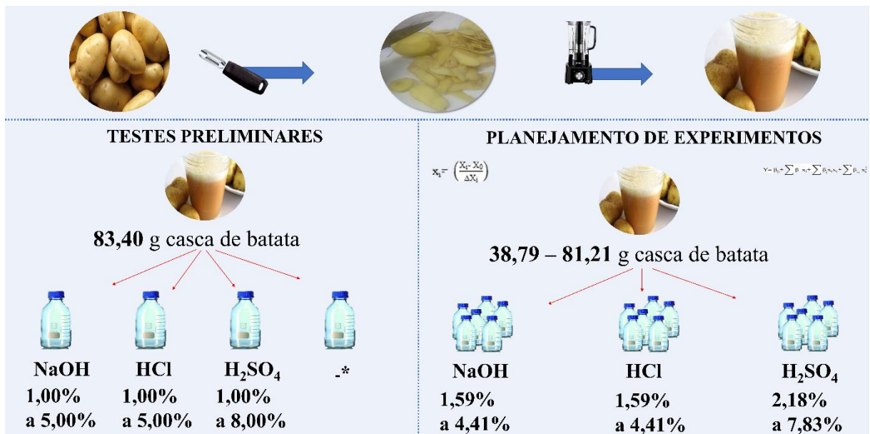
Figura 6 - Fluxograma das etapas de corte e trituração da casca de batata utilizada nos ensaios preliminar e de planejamento experimental
