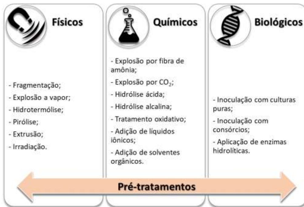
Figura 3.3. Resumo dos principais métodos físicos, químicos e biológicos de tratamento da biomassa lignocelulósica.
