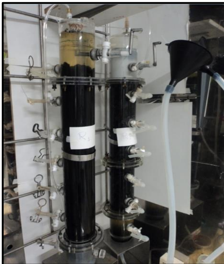
Figura 3. Reatores anaeróbios – FVR (à esquerda) e PBR (à direita).
