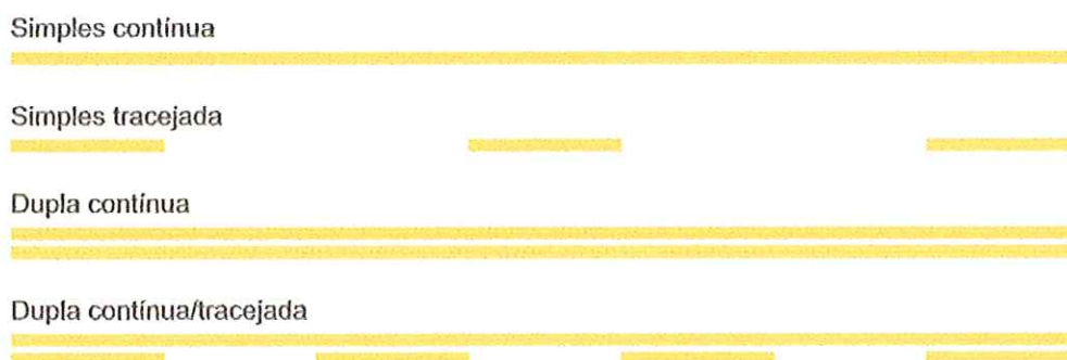
FIGURA 8: Sinalização horizontal - marcas longitudinais
