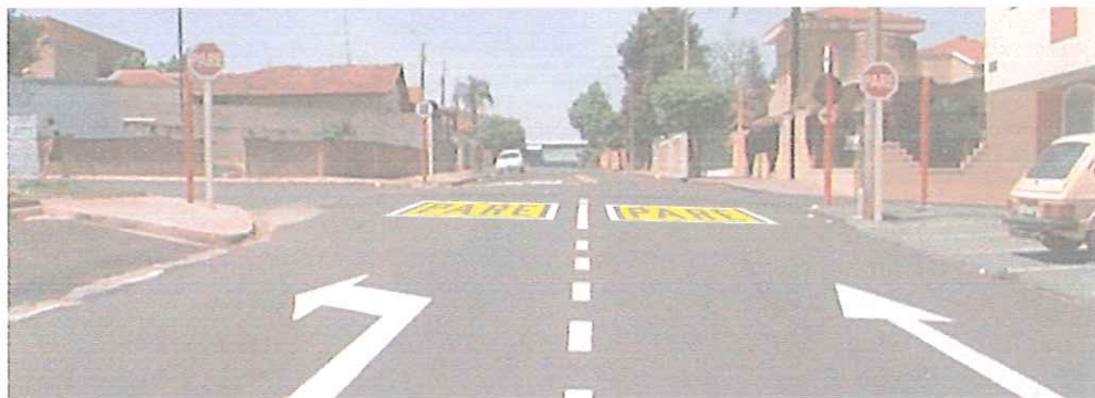
FIGURA 32: Imagem editada com o modelo de parada obrigatória implantado em São Carlos Fonte: imagem editada pelo autor
