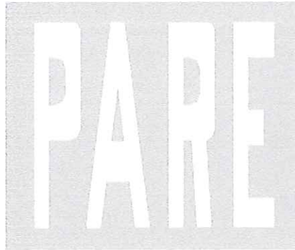
FIGURA 27: Modelo de parada obrigatória padronizado pelo CTB
