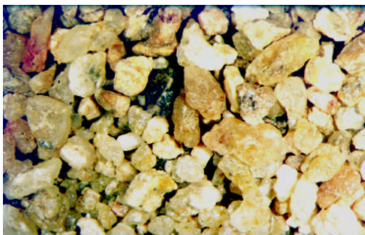
Figura 4.3 : Grãos da areia do rio Acaraú com diâmetro entre 2,00 e 0,42 mm (aumento de 10 X)
