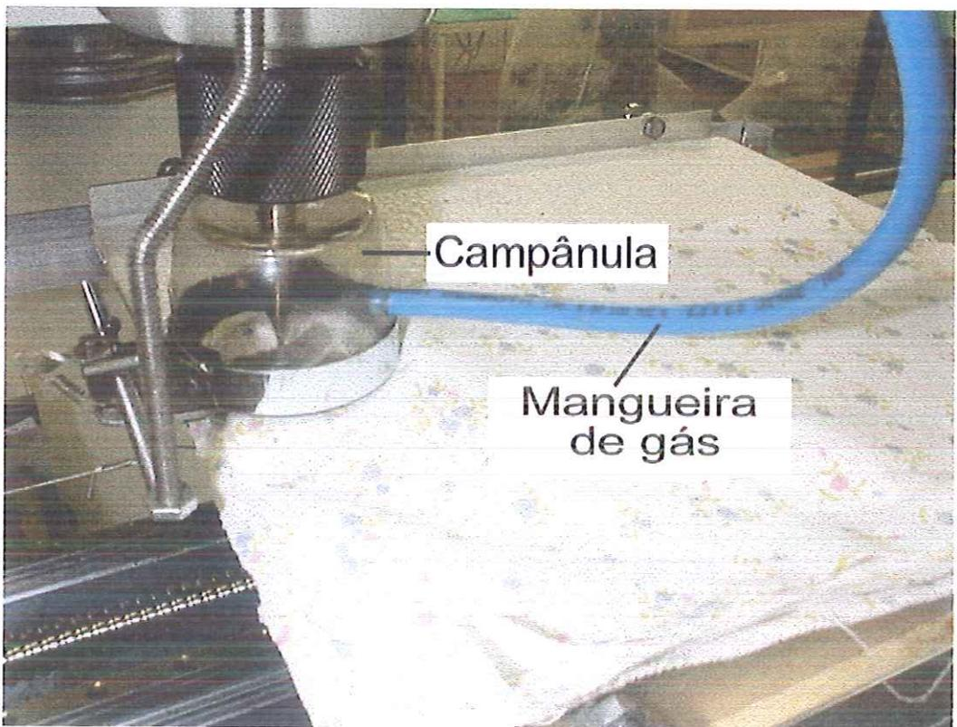
Figura 5.16 Vista da campânula com a ferramenta em seu interior e da mangueira conectada a ela para o suprimento de gás nitrogênio.
