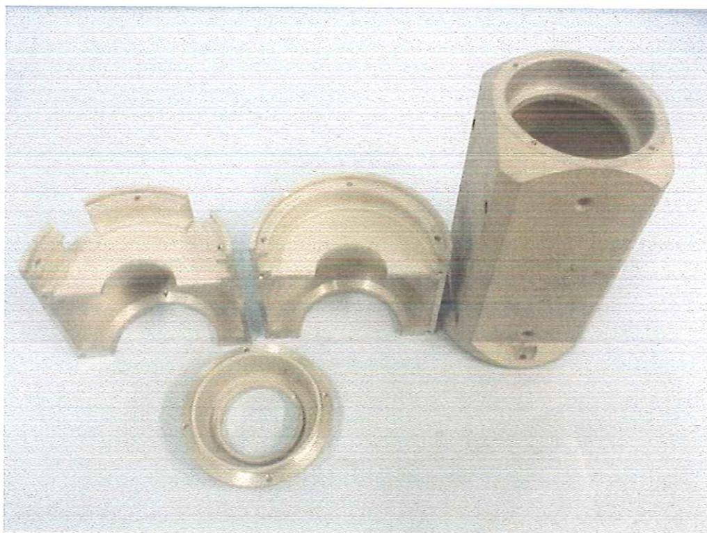
Figura 5.12 Invólucro bi-partido, caixa estrutural e tampa.
