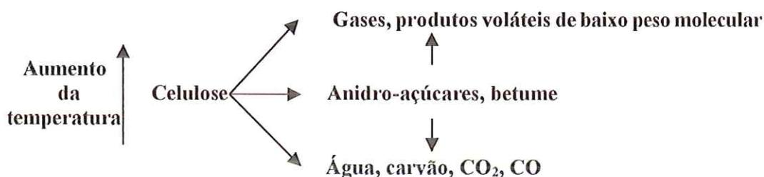
Figura 2.2 Reações que competem na pirólise da celulose (figura retirada de SHAFIZADEH, 1985).
