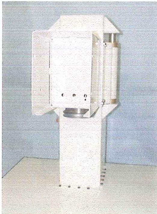
Figura 5.4 Caixa horizontal ligada à coluna mostrando o alojamento para o motor elétrico situado no seu interior.
