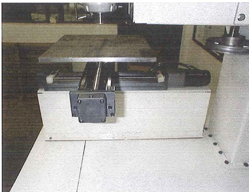
Figura 5.5 Mesa de coordenadas onde se observam os dois atuadores lineares posicionados transversalmente um em relação ao outro.
