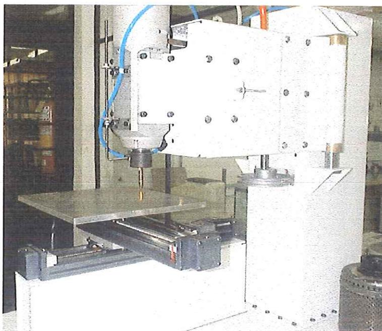
Figura 1.3 Equipamento de corte onde se vê a ferramenta aquecida ao rubro.
