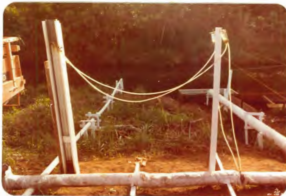
FIG. 3.18 - Sistema de medição de vazão. Abaixo e à direita vê-se o diafragma; acima os eliminadores de bolha e à esquerda o manômetro
