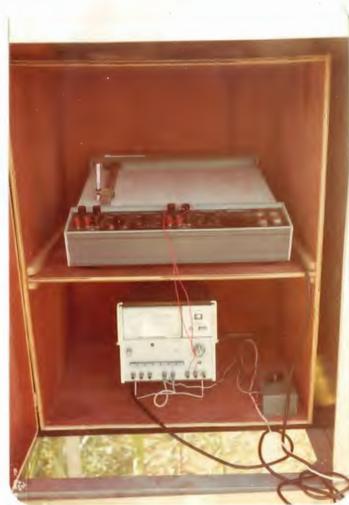
FIG. 3.14 - Instrumentos para medição de temperatura, vendo-se acima o registrador e abai- xo o microvoltímetro e chave seletora.
