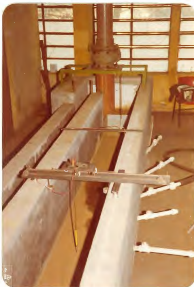
FIG. 3.6 - Vista da canaleta, vendo-se as entradas laterais de água quente, a sonda para medições do perfil transversal de temperatura e, em segundo plano, os tubos de alimentação de água fria.
