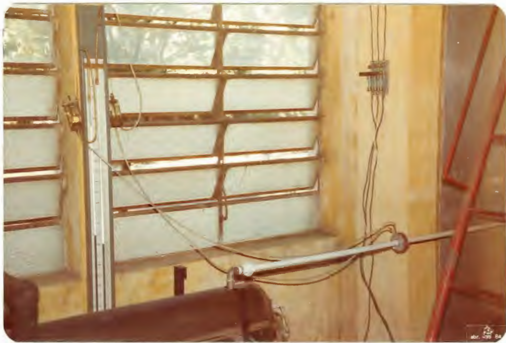
FIG. 3,8 - Medidor de vazão, vendo-se o diafragma à direita e o manômetro à esquerda.
