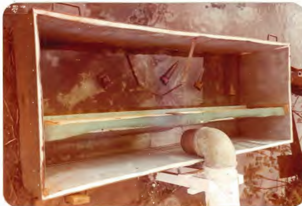
FIG. 3.19 - Caixa d'água, vendo-se o tubo de alimentação, a tela divisória, os tubos de adução e a haste de fixação do termopar.
